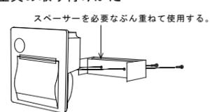
★固定金具用スペーサーは取付パネル厚に応じて次の表を目安に使用してください。正しく使用しない場合、筐体に歪が生じ、ペーパーカバーが開け辛くなったり、印字品質が劣化する場合があります。(取付パネル厚が 2.2mm を越えると止めが緩くなる可能性があります。)
