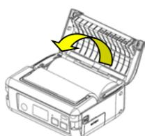
③用紙の先端をペーパーカッターより前に出して、ペーパーカバー両端を押して閉じます。
