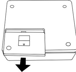
バッテリーパックを マークが右に来るようにして、バッテリーケースの左側の方に置き、右側へカチッと音がするまでスライドさせます。
